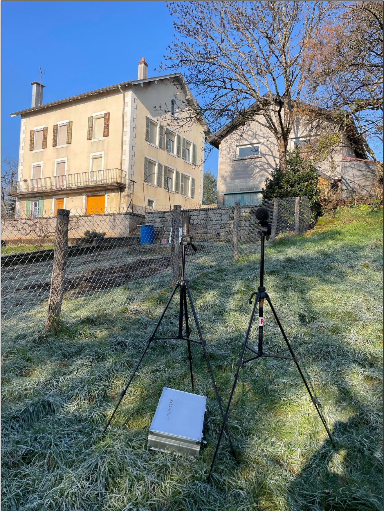
Figure 20 : Photographie du sonomètre lors des mesures des niveaux sonores en limite de Zone à Emergence Réglementée (Point ZER-1 sur Figure 1)
