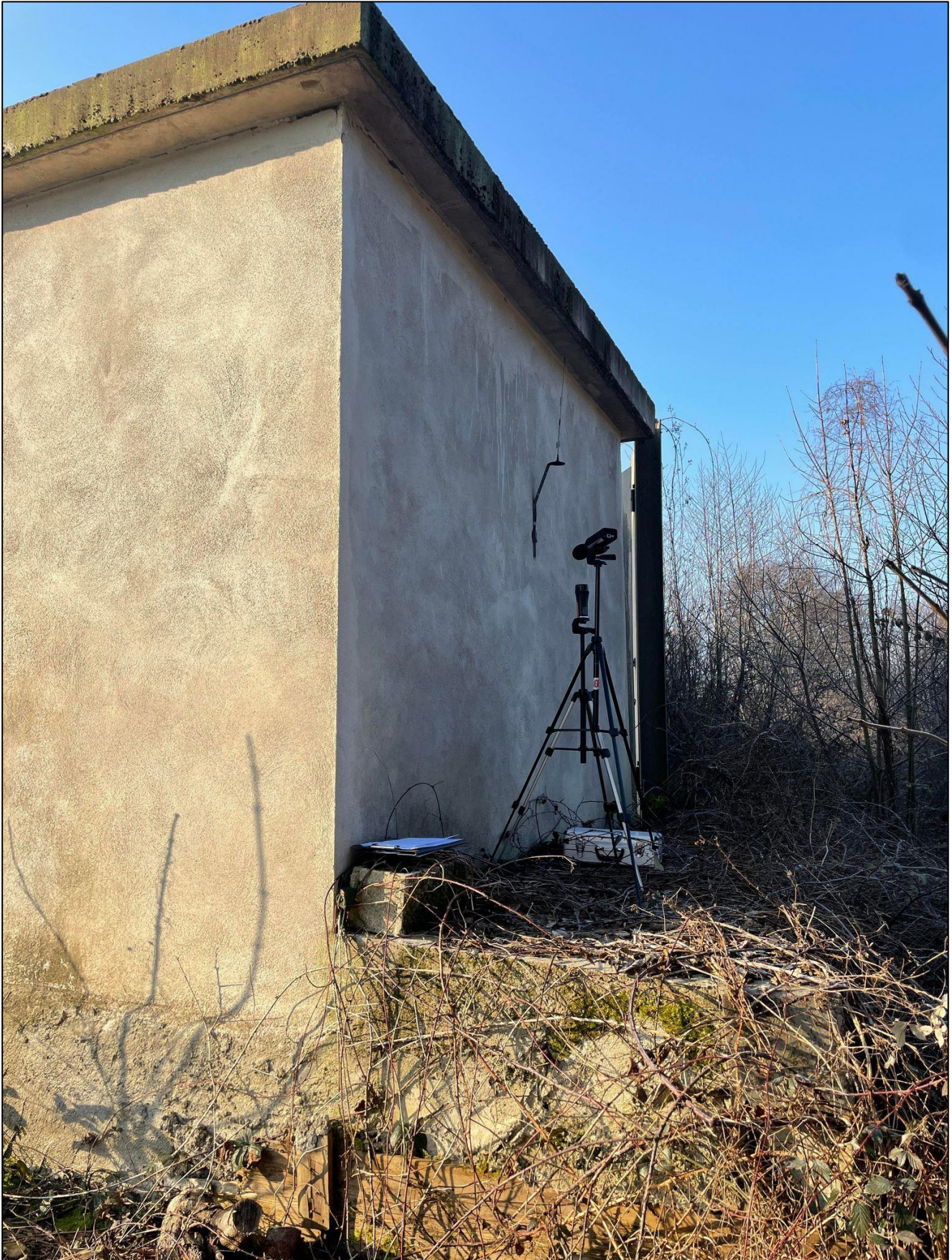
Figure 19 : Photographie du sonomètre lors de la mesure du niveau sonore en limite de site (point LIM-3 sur la Figure 1)
