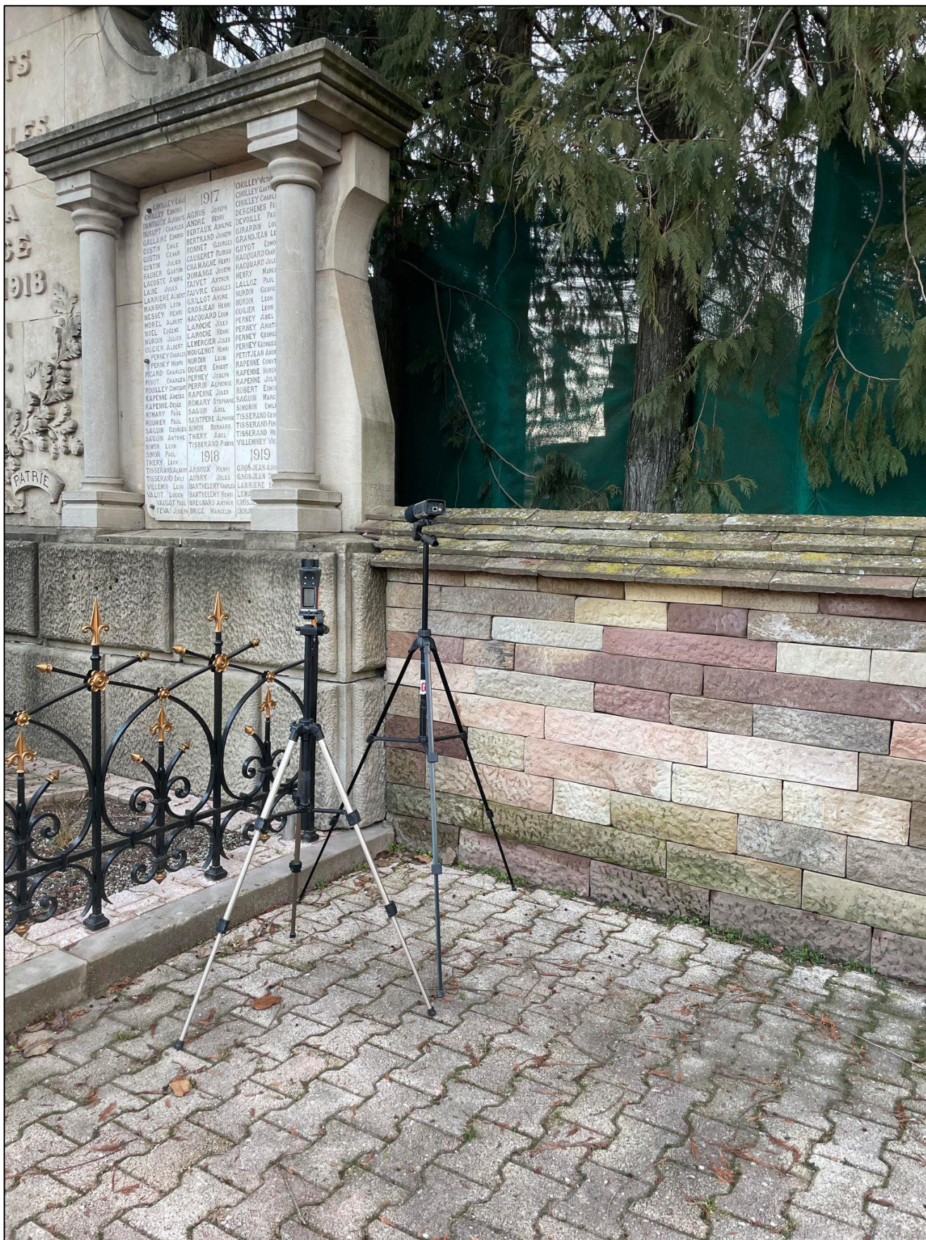
Figure 17 : Photographie du sonomètre lors de la mesure du niveau sonore en limite de site (point LIM-2 sur la Figure 1)
