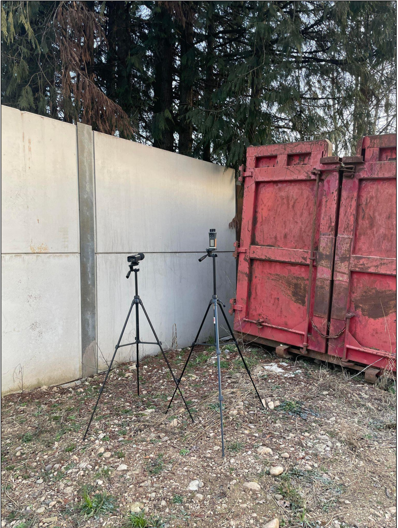
Figure 18 : Photographie du sonomètre lors de la mesure du niveau sonore en limite de site (point LIM-2/ZER-2 sur la Figure 1)
